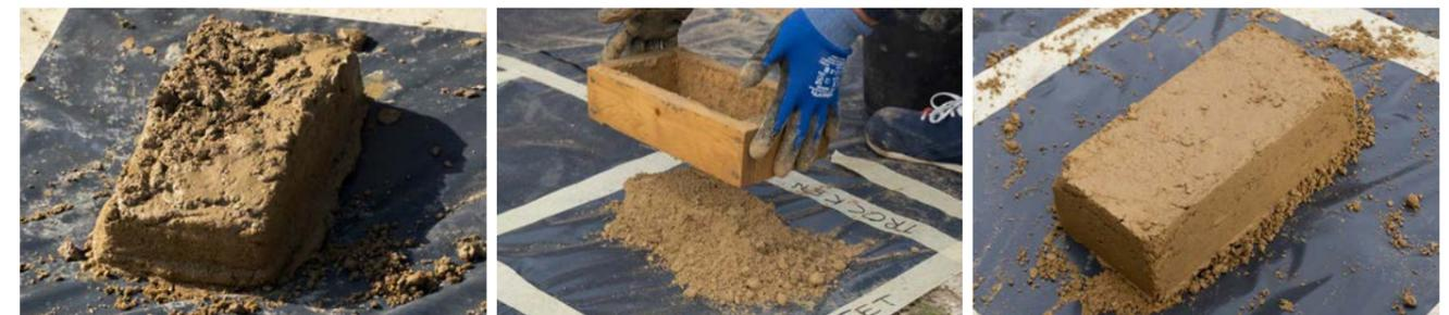
Von links nach rechts: Abb. 12: zu nass, Abb. 13: zu trocken und Abb. 14: ein gutes Mischungsverhältnis
