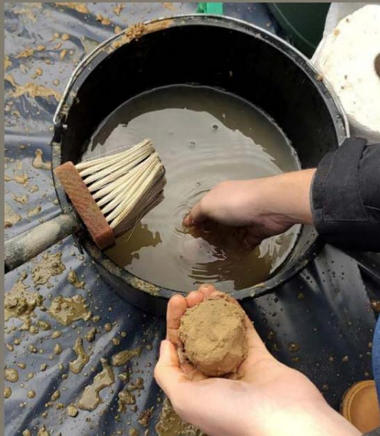
Abb. 04: Kugelformtest
