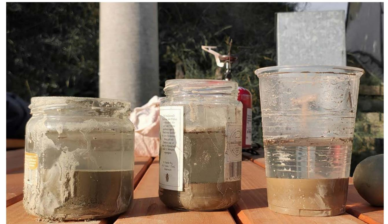
Abb. 07: Sedimentationstest
