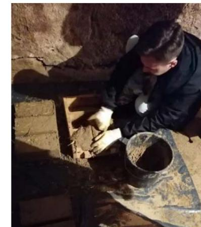
Abb. 06: Wuchtiges Befüllen des Modells mit der Masse
