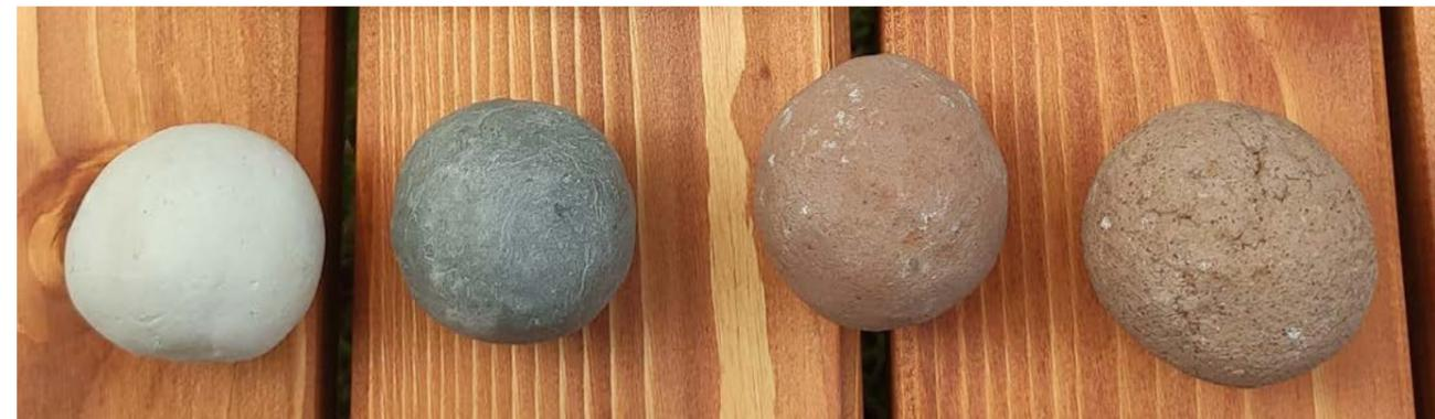
Abb. 02: Im Bild v.l.n.r.: Kaolinit, thixotrope Erde, fetter Lehm und sandiger Lehm (Thixotrope Erde wird weich durch Kneten und härtet in Ruhelage)
