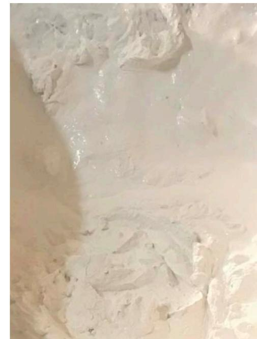
Abb. 04: Selbst hergestellter Sumpfkalk
